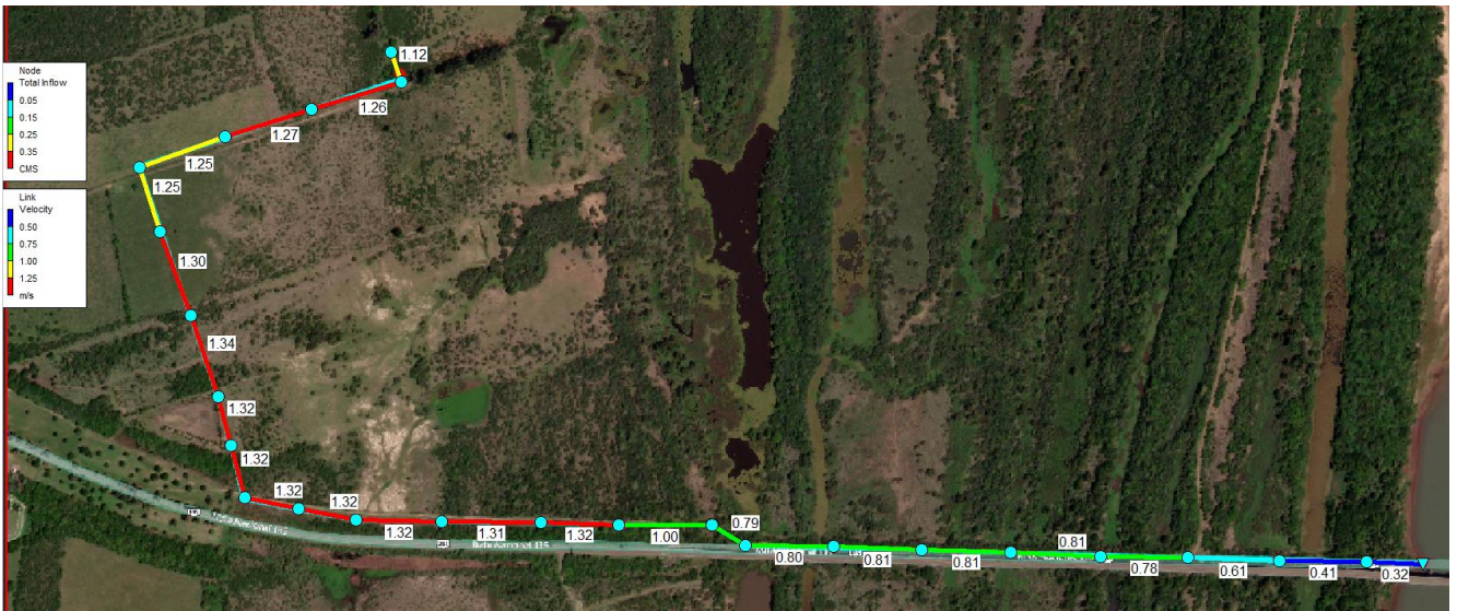
Figura 73 Mapa de valores de velocidad en conductos. Escenario 2.
