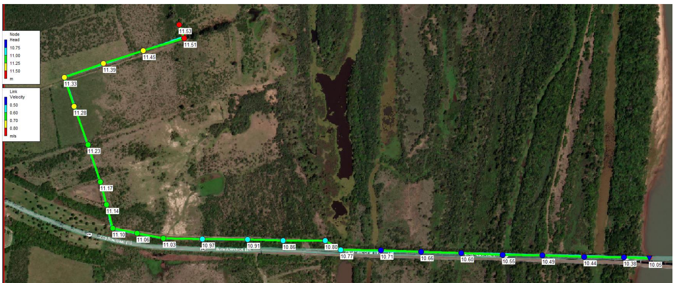
Figura 70 Mapa de valores de nivel piezométrico en nodos. Escenario 1.
