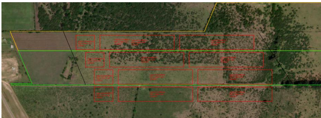
Figura 12 Layout general de las lagunas de la Alternativa 2.
